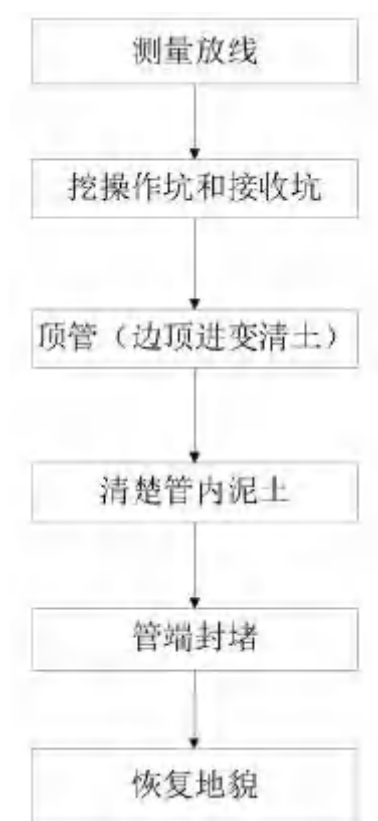
图 2.2-13 顶管施工工艺流程与产污环节图
