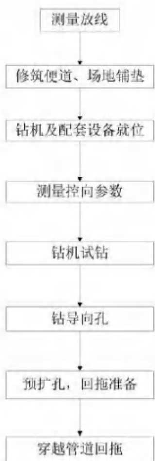
图 2.2-12 水平定向钻施工工艺流程与产污环节图
